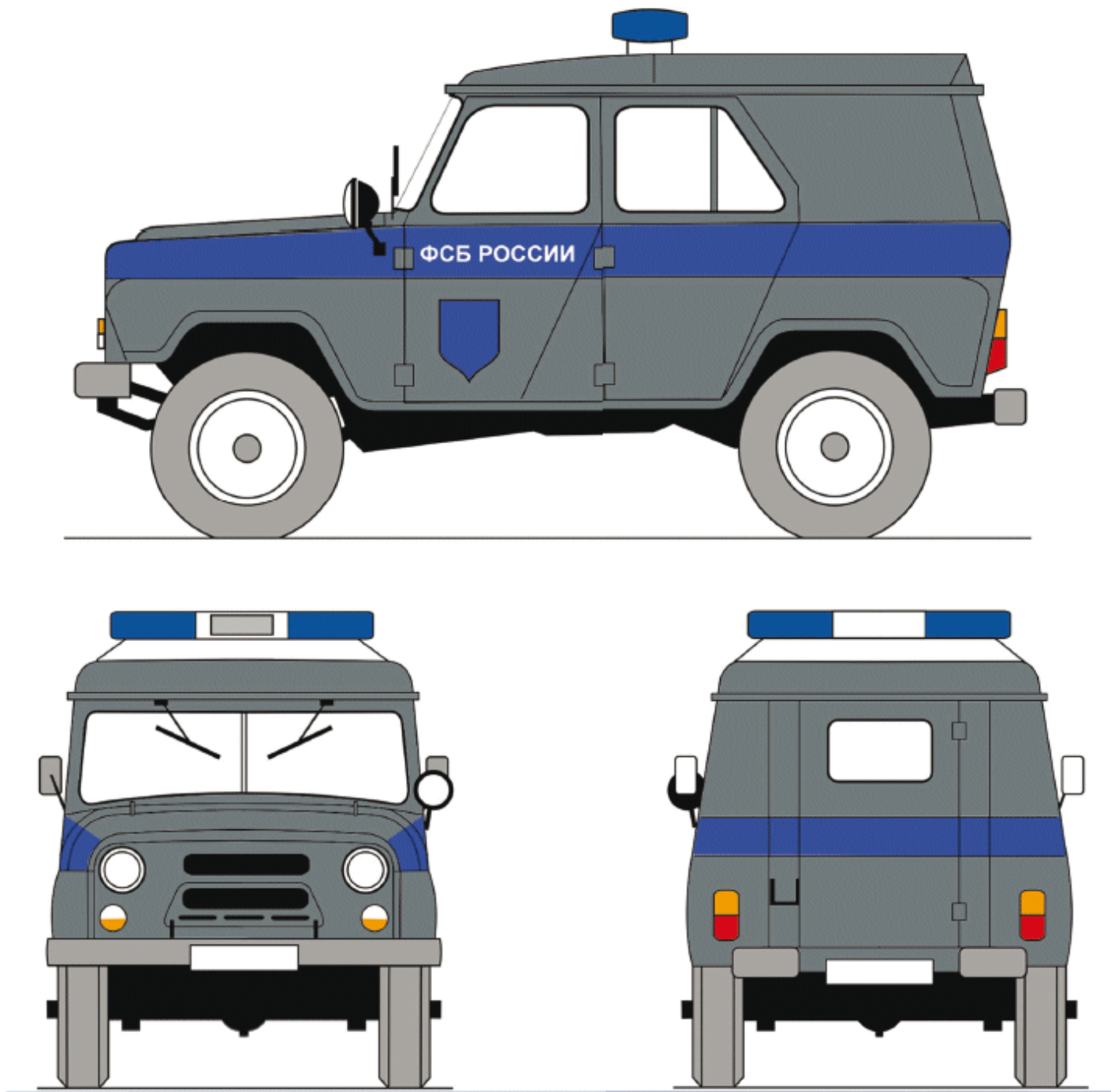
Рисунок А.33 - Цветографические схемы автомобилей органов Федеральной службы безопасности, используемых для проведения неотложных действий по разминированию
